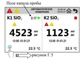
Рисунок Г.6 — Экран «АВТОМАТИЧЕСКОЕ ИЗМЕРЕНИЕ» общий для каналов пробы (на примере экрана для анализатора исполнений МАРК-1202-X-П2С)
