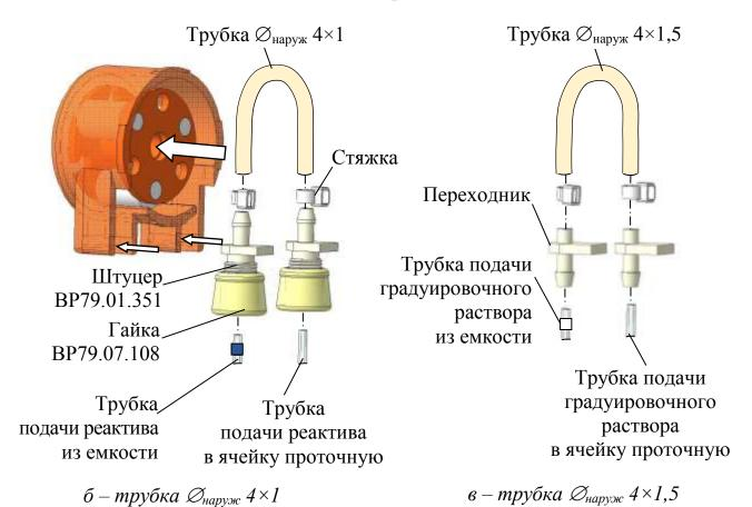
Рисунок 3.4 — Расположение трубок  $\mathcal{O}_{\text{наруж}}$   $4 \times 1$  и  $\mathcal{O}_{\text{наруж}}$   $4,5 \times 1$
