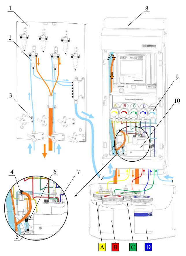
Рисунок 1.2 – Гидравлическая схема
