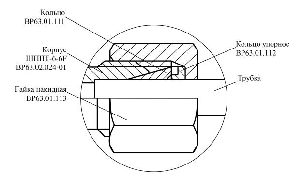
Рисунок Е.1 – Установка трубки в штуцер ШППТ-6-6F ВР63.02.020-06
