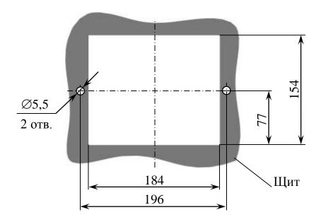
Pисунок 2.5 - Pазметка в щите для крепления блока преобразовательного
