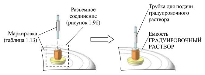
Рисунок 2.18 — Подсоединение трубки для подачи градуировочного раствора к емкости ГРАДУИРОВОЧНЫЙ РАСТВОР
