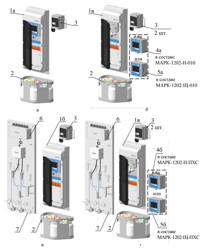
1a- модуль измерительный BP79.01.000-01; 16- модуль измерительный BP79.01.000; 1b- модуль измерительный BP79.01.000-02; 2- подставка BP79.07.000; 3- источник питания ИП-1002 BP49.04.000; 4a- блок преобразовательный BP79.01.100-01; 46- блок преобразовательный BP79.01.100; 5a- блок преобразовательный BP79.01.100-03; 56- блок преобразовательный BP79.01.100-02; 6- блок сигнализации BP79.03.000; 7- панель переключения пробы BP79.02.000, BP79.02.000-01...04
