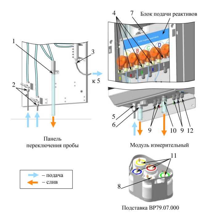
1, 6, 10 — штуцер сливной; 2, 3, 5 — штуцер подачи пробы (штуцер ШППТ-6-6F ВР63.02.020-06  $\varnothing$  6 мм); 4 — штуцер ВР79.01.351; 7 — переходник; 8 — разъемное соединение емкости ГРАДУИРОВОЧНОГО РАСТВОРА; 9, 12 — кабельный ввод; 11 — разъемное соединение емкостей А...D
