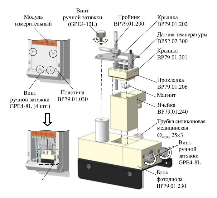
Рисунок 3.1 – Извлечение ячейки проточной ВР79.01.240
