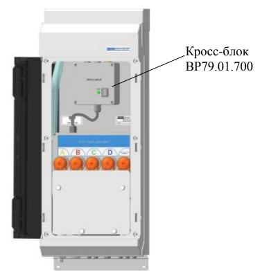
Рисунок 1.4 – Модуль измерительный ВР79.01.000-02 (остальное см. рисунок 1.3)
