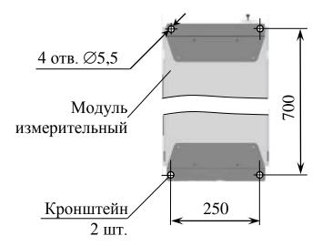
Рисунок 2.2 – Расположение отверстий для крепления модуля измерительного
