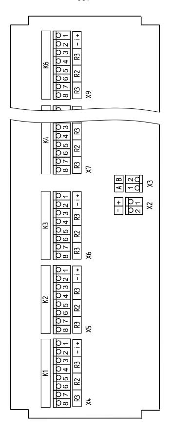
Pисунок Д.4 — Cхема расположения разъемов на плате блока сигнализации
