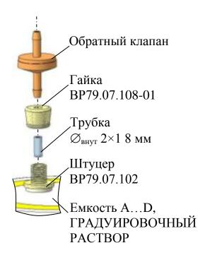
Рисунок 3.5 – Расположение трубки  $\mathcal{O}_{\text{внут}}$  2×1
