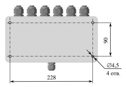
Рисунок 2.8 — Расположение и размер отверстий для крепления блока сигнализации BP79.03.000
