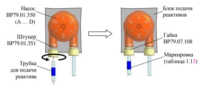
Рисунок 2.15 – Подсоединение трубок подачи реактивов к насосам А... D
