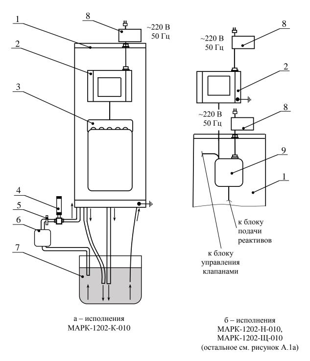
— модуль измерительный; 2 — блок преобразовательный; 3 — блок подачи реактивов; 4 — ротаметр; 5 — зажим; 6 — насос; 7 — емкость с дистиллированной водой; 8 — источник питания ИП-1002; 9 — кросс-блок
