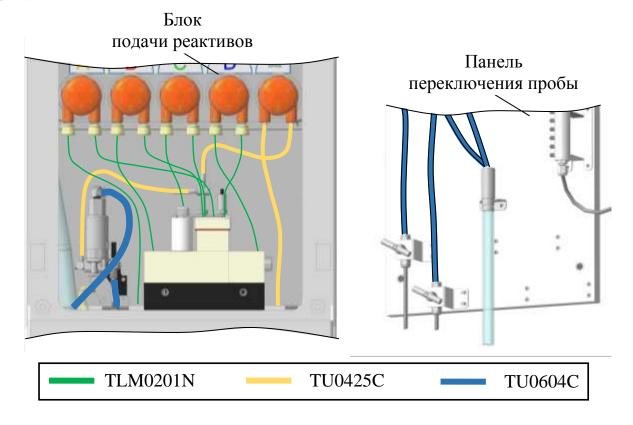
Рисунок 3.3 – Расположение трубок TLM0201N, TU0425C и TU0604C
