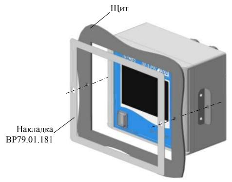
Рисунок 2.6 — Установка блока преобразовательного BP79.01.000-02 либо BP79.01.000-03 в щит
