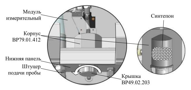
Рисунок 3.2 – Замена фильтрующего материала (синтепона)
