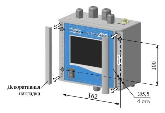
Рисунок 2.4 — Расположение и размер отверстий для крепления блока преобразовательного BP79.01.100 (BP79.01.100-01)
