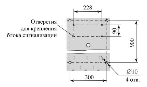
Рисунок 2.7 — Расположение и размер отверстий для крепления панели переключения пробы BP79.02.000, BP79.02.000-01...04
