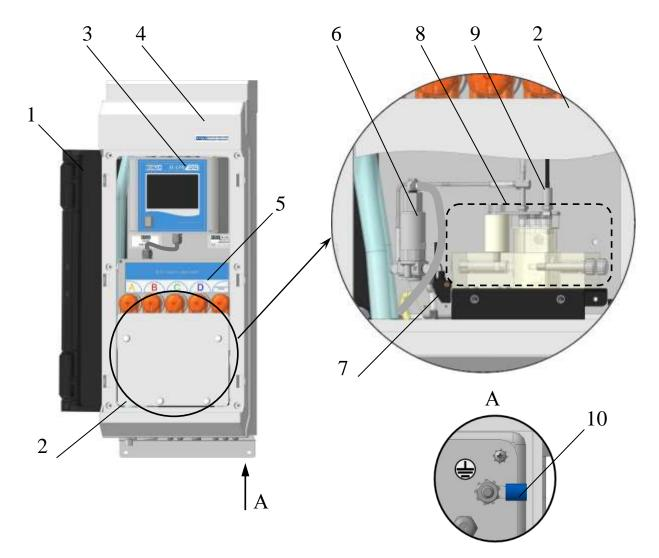
1 — крышка BP52.00.003; 2 — пластина BP79.01.030; 3 — блок преобразовательный BP79.01.100 или BP79.01.100-01; 4 — корпус BP79.01.002; 5 — блок подачи реактивов BP79.01.300; 6 — клапан BP79.01.430; 7 — датчик давления PSF 102 7651-711; 8 — ячейка проточная BP79.01.200; 9 — датчик температуры BP52.02.300; 10 — клемма заземления (НКИ 2,5 — 6)
