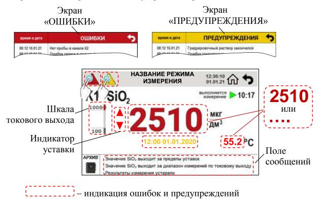
Рисунок 2.21 – Индикация ошибок и предупреждений
