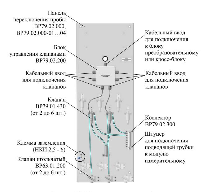
Рисунок 1.6 – Панель переключения пробы BP79.02.000, BP79.02.000-01...04
