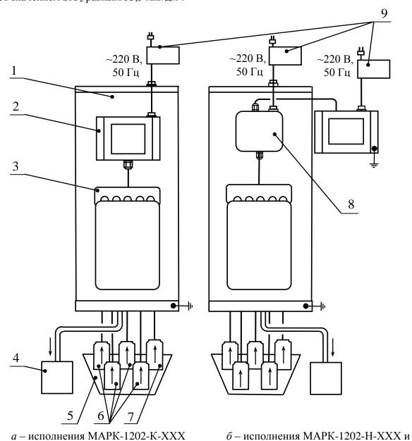
1- модуль измерительный; 2- блок преобразовательный; 3- блок подачи реактивов; 4- емкость для слива; 5- подставка; 6- емкость с реактивом; 7- емкость с контрольным раствором; 8- кросс-блок; 9- источник питания ИП-1002
