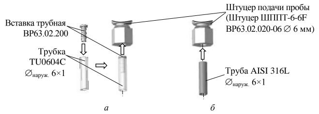
Рисунок 2.11 – Подсоединение трубок для подачи пробы
