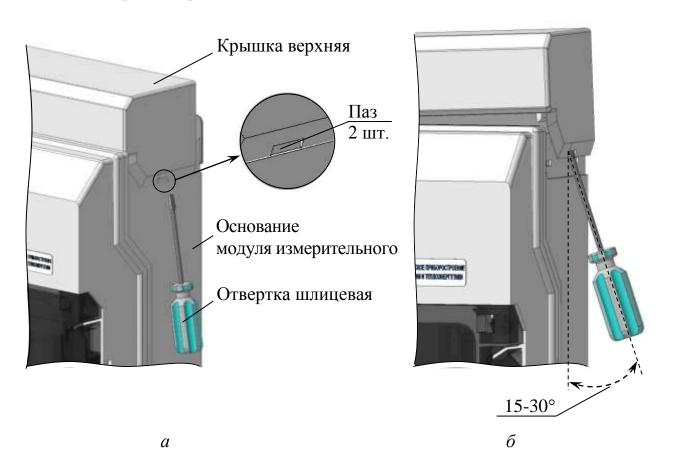
Рисунок 2.1 – Демонтаж верхней крышки модуля измерительного
