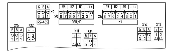
Pисунок Д.1 – Cхема расположения разъемов на плате блока преобразовательного
