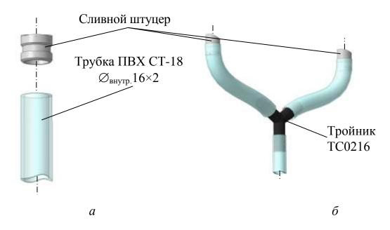
Рисунок 2.12 – Подсоединение сливной трубки
