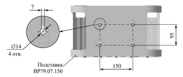
Рисунок 2.9 — Расположение и размер отверстий для крепления подставки BP79.07.150 на вертикальную поверхность
