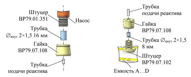
Рисунок 3.6 – Расположение трубок  $\mathcal{Q}_{\text{внут}}$  2×1,5
